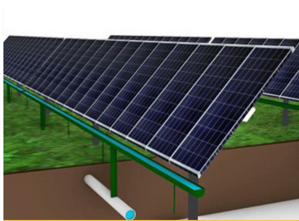
Figura 17: Impianto fotovoltaico con recupero dell'acqua piovana. Fonte: Rain Water Recovery.
